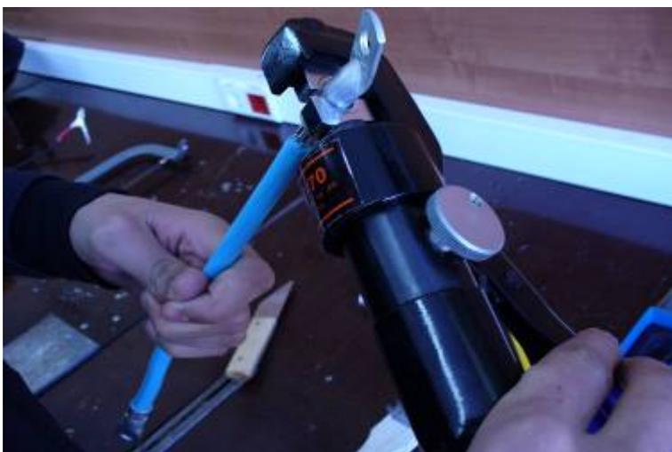
При опрессовке сплошным обжатием создается большое давление и хороший электрический контакт на всем протяжении обжатия.
